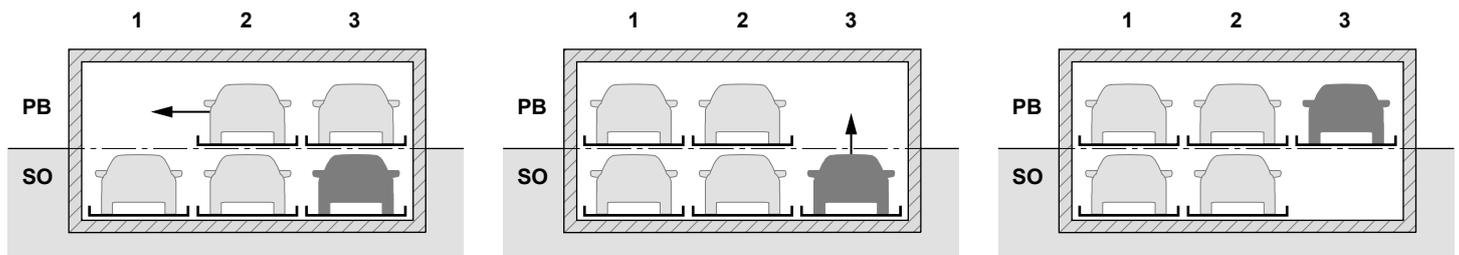
Para desaparcar el vehículo de la plaza de aparcamiento en el **módulo 3 / SO**, las plataformas de PB se desplazan hacia la izquierda.
